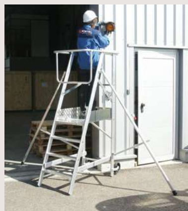
Roues Ø 200 mm non porteuses en position de travail - Spécial BTP
