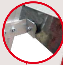
Aimant pour maintien en position côté camion
