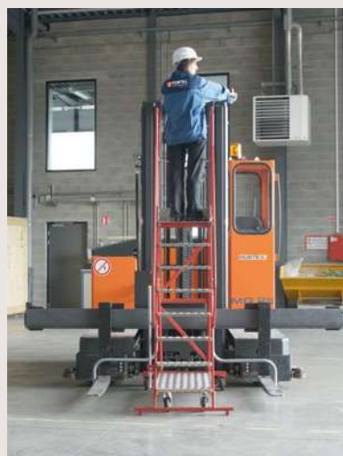
Stabilisateurs pivotants ou télescopiques pour un gain de place dans les rayons
