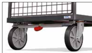
TOTALSTOP – Le système de blocage centralisé fetra Une simple pression du pied suffit à bloquer à la fois la rotation et le déplacement des roues. La pédale restant toujours visible.
